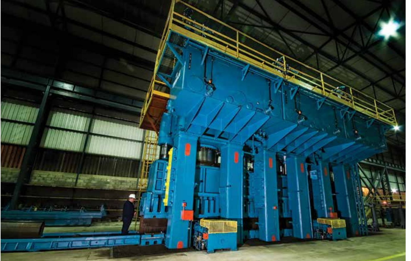
Akçakoca Fabrika, "0" Press 20.000 ton Max. O.D 42" Max W.T 1"
