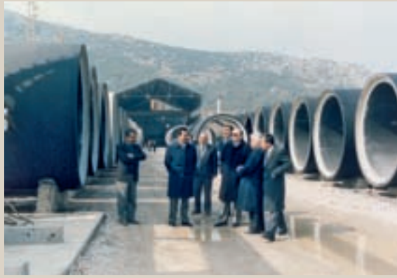
İç yüzeyleri PVC malzeme ile kaplanmış 2400mm betonarme boru imalattan İzmir kanalizasyon projesi ana kollektör hattını da kullanılmıştır
